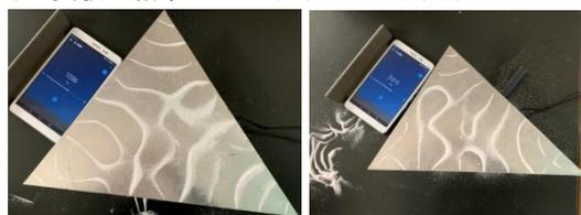
図4 実験 3 結果 1056Hz(左) 1015Hz(右)
