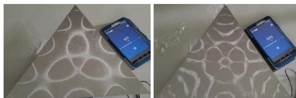
図3 実験 2 結果 673Hz(左) 1272Hz(右)
